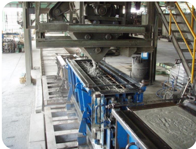
生コン投入状況
