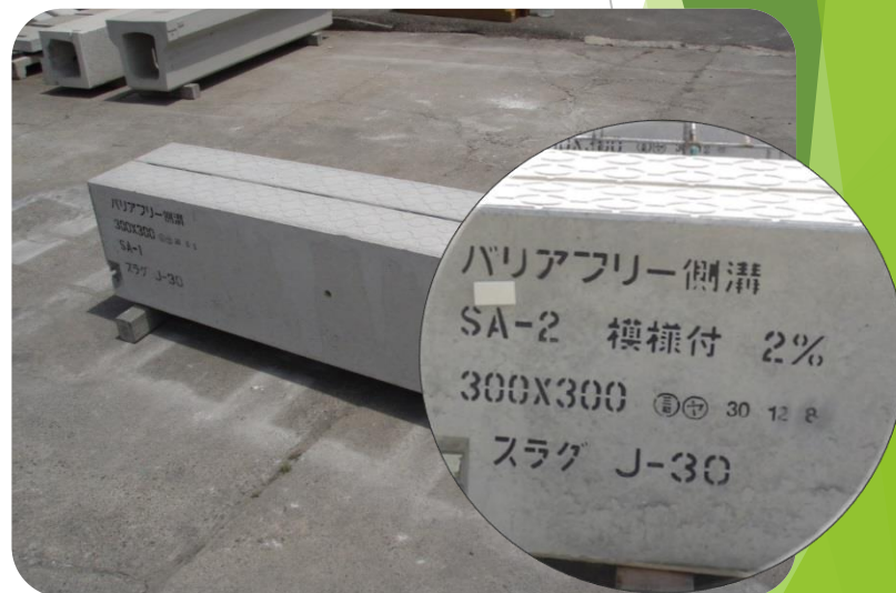
外観検査・製品表示確認
