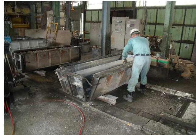
③型枠の清掃
