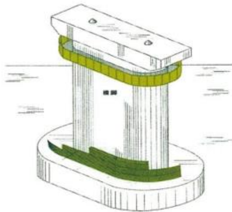
一般ライナープレート工法
